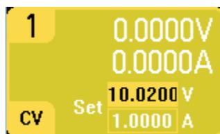
3. **Settings** キーを押して Source Settings ウィンドウを表示します。ナビゲーション・キーを使って、**Voltage** または **Current** フィールドを強調表示します。次に、電圧／電流値を数字キーで入力します。**Enter** キーを押して値を入力します。
